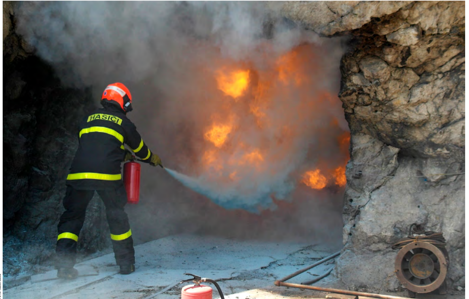
Hašení metanu práškovým hasičím přístrojem.
