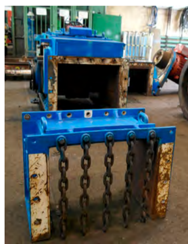
Drtič uhlí po opravě.
